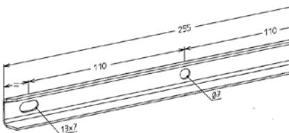
**ÉCLISSE À BOULONNER - COUPLER BOLT**
