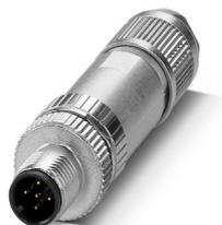
Connecteur de données, CANopen<sup>®</sup>, DeviceNet<sup>™</sup>, 5-pôles, blindé, connecteur mâle droit M12, détrompage: A, Raccordement à ressort Push-Lock, matériau de la molette: Zinc moulé sous pression, nickelé, diamètre extérieur du câble 4 mm ... 8 mm
