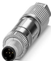
Connecteur de données, CANopen<sup>®</sup>, DeviceNet<sup>™</sup>, 5-pôles, exempt d'halogène, blindé, connecteur mâle droit M12, détrompage: A, Raccordement autodénudant, matériau de la molette: Zinc moulé sous pression, nickelé, diamètre extérieur du câble 5 mm ... 9,7 mm
