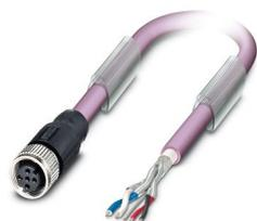
Câble préconfectionné pour bus, CANopen<sup>®</sup>, DeviceNet<sup>™</sup>, 5-pôles exempt d'halogène, blindé, extrémité libre, sur Connecteur femelle droit M12, détrompage: A, longueur de câble: Longueur au choix (0,2... 40,0 m)
