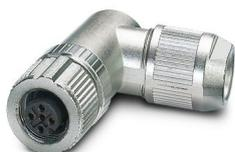
Connecteur de données, CANopen<sup>®</sup>, DeviceNet<sup>™</sup>, 5-pôles, blindé, connecteur femelle coudé M12, détrompage: A, Raccordement à ressort Push-Lock, matériau de la molette: Zinc moulé sous pression, nickelé, diamètre extérieur du câble 4 mm ... 8 mm
