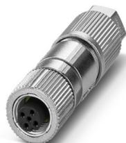
Connecteur de données, CANopen<sup>®</sup>, DeviceNet<sup>™</sup>, 5-pôles, exempt d'halogène, blindé, connecteur femelle droit M12, détrompage: A, Raccordement autodénudant, matériau de la molette: Zinc moulé sous pression, nickelé, diamètre extérieur du câble 5 mm ... 9,7 mm
