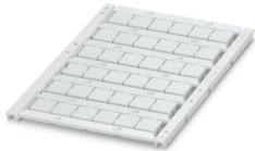
Repères pour blocs de jonction, Planche, blanc, vierge, repérable avec : TOPMARK NEO, LASER TOPMARK, BLUEMARK ID COLOR, BLUEMARK ID, BLUEMARK CLED, THERMOMARK PRIME, THERMOMARK CARD 2.0, THERMOMARK CARD, type de montage: encliquetage, pour bloc de jonction au pas de : 10,2 mm, surface utile: 8,9 x 9,6 mm, Nombre d'étiquettes: 36
