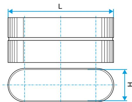
Schéma d'encombrement Raccord Femelle Oblong
