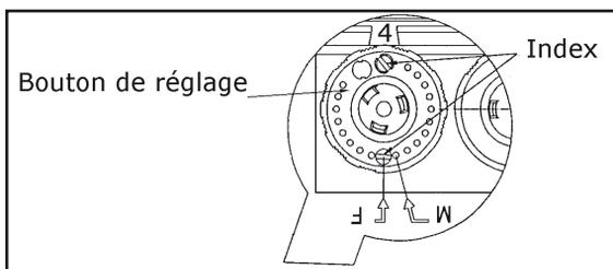
Pour obtenir une température fixe préalablement réglée placer l'index dans le trou face au F.
