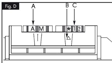
Le thermostat électronique d'ambiance permet de maintenir avec précision (à 1/10e de degré près) une température constante dans le local. Un voyant lumineux permet la visualisation des cycles de chauffe de l'appareil (Rep. B Fig. D ).
