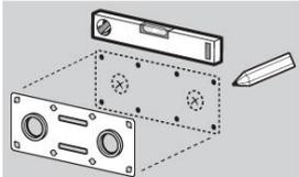
2 - Percer la plaque de plâtre avec une scie cloche (Ø 50 mm). Percer 8 trous (diamètre 7 mm) et enfiler les chevilles à expansion directement sous la platine.
