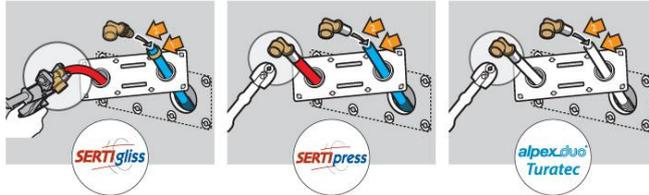
5 - Orienter la position des raccords à l'aide des crans au dos de la plaque. Enclencher les raccords jusqu'au "clic" de fixation. Visser les bagues de couleur à l'aide des ergots rouge et bleu.
