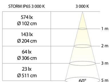
Luminance (lx) - Diamètre du cône (Ø cm) - Distance (m)
