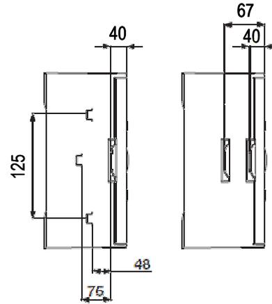
**Pattes de fixation - ST VTR/ST VTR INOX**
