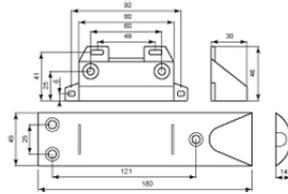
Le 450-FR a été spécialement conçu pour être utilisé sur des portes de garages basculantes mais aussi sur les rideaux et stores métalliques. Il est équipé d'un câble sous gaine métallique de 1,2 mètre.
