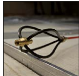
Le fouet permet de guider les câbles sur des surfaces rugueuses ou inégales et de passer des obstacles.
