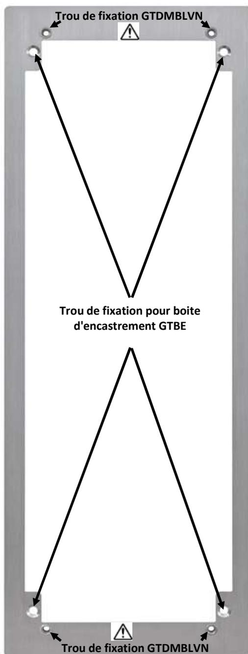
⚠ Prévoir perçage  $\varnothing$  8mm dans le mur pour passage goujon pour trou de fixation GTDMBLVN
