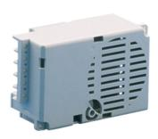
HP-micro pour plaques de rue LOGICOM, VANDALCOM, UNICOM et en laiton série FIRENZE avec double amplificateur, réglage des 2 volumes, haut-parleur étanche et micro à électret. A utiliser dans les systèmes traditionnel et digitale Comelbus. Dimensions: 95x55x33 mm .
