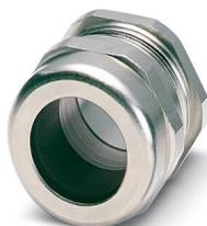
Presse-étoupe métallique jusqu'à 5 bars, longueur de filet : 7 mm, diamètre du câble : 14 - 21 mm, ouvert. 34, presse-étoupe : M25
