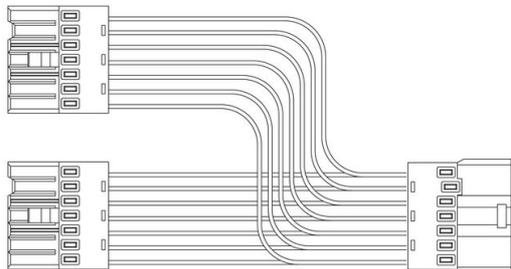
in policarbonato. Da utilizzare come giunzione a 'T', per collegare elettricamente 3 canali art. 6001/6002/6003. Usare in abbinamento all'acc. 6020.
