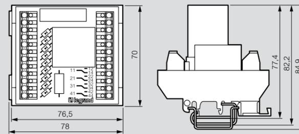
De raccordement pour capteurs (réf. 0 366 34)
