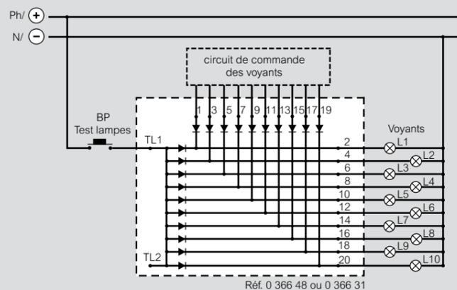
La protection du circuit de commande est assurée par une série de diodes interdisant le retour du signal
