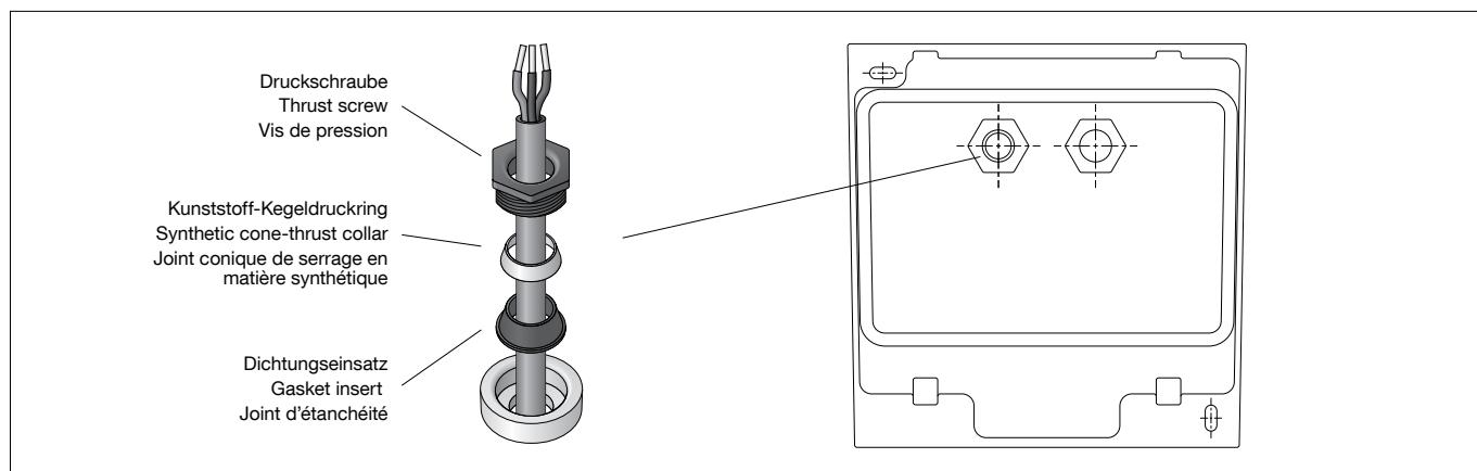
Dabei den beiliegenden Kunststoff-Kegeldruckring zwischen Dichtungseinsatz und Druckschraube (SW 22) verwenden (siehe Skizze).
