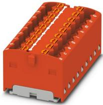
Bloc distributeur, pontage interne, tension nominale: 450 V, intensité nominale: 17,5 A, nombre de connexions: 18, type de raccordement: Raccordement Push-in, section : 0,14 mm<sup>2</sup> - 2,5 mm<sup>2</sup>, type de montage: encliquetage sur l'adaptateur de profilé, Montage direct avec bride, Volant, coloris: rouge
