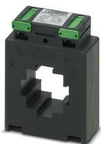
Transformateur de courant enfichable, courant primaire 400 A AC, courant secondaire 5 A AC ; classe de précision 1 ; puissance assignée 7,5 VA
