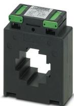
Transformateur de courant enfichable, courant primaire 300 A AC, courant secondaire 5 A AC ; classe de précision 1 ; puissance assignée 7,5 VA
