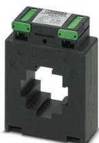
Transformateur de courant enfichable, courant primaire 1000 A AC, courant secondaire 5 A AC ; classe de précision 1 ; puissance assignée 10 VA
