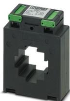
Transformateur de courant enfichable, courant primaire 250 A AC, courant secondaire 5 A AC ; classe de précision 1 ; puissance assignée 5 VA
