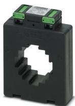
Transformateur de courant enfichable, courant primaire 200 A AC, courant secondaire 5 A AC ; classe de précision 1 ; puissance assignée 5 VA
