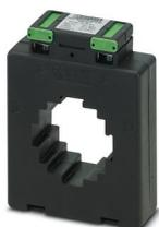
Transformateur de courant enfichable, courant primaire 600 A AC, courant secondaire 5 A AC ; classe de précision 1 ; puissance assignée 15 VA
