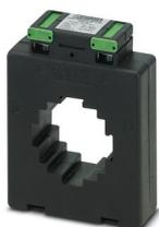
Transformateur de courant enfichable, courant primaire 400 A AC, courant secondaire 5 A AC ; classe de précision 1 ; puissance assignée 10 VA
