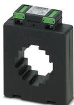
Transformateur de courant enfichable, courant primaire réglable de 100 à 1500 A AC ; courant secondaire réglable sur 1 A AC ou 5 A AC ; classe de précision réglable sur 0,5 ou 1 ; puissance assignée réglable
