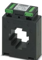
Transformateur de courant enfichable, courant primaire réglable de 75 à 1000 A AC ; courant secondaire réglable sur 1 A AC ou 5 A AC ; classe de précision réglable sur 0,5 ou 1 ; puissance assignée réglable
