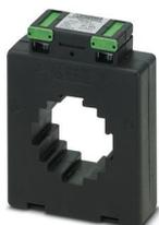
Transformateur de courant enfichable, courant primaire 500 A AC, courant secondaire 5 A AC ; classe de précision 1 ; puissance assignée 15 VA
