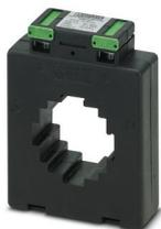
Transformateur de courant enfichable, courant primaire 1500 A AC, courant secondaire 5 A AC ; classe de précision 1 ; puissance assignée 15 VA
