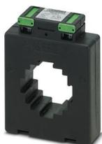
Transformateur de courant enfichable, courant primaire 800 A AC, courant secondaire 5 A AC ; classe de précision 1 ; puissance assignée 10 VA
