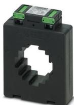
Transformateur de courant enfichable, courant primaire 300 A AC, courant secondaire 5 A AC ; classe de précision 1 ; puissance assignée 10 VA
