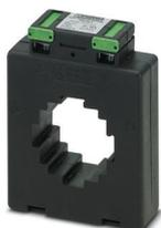
Transformateur de courant enfichable, courant primaire 600 A AC, courant secondaire 5 A AC ; classe de précision 1 ; puissance assignée 10 VA
