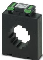
Transformateur de courant enfichable, courant primaire 150 A AC, courant secondaire 5 A AC ; classe de précision 1 ; puissance assignée 3,75 VA
