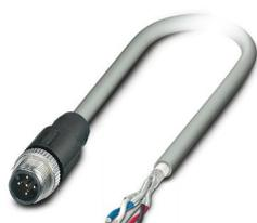
Câble préconfectionné pour bus, CANopen<sup>®</sup>, DeviceNet<sup>™</sup>, 5-pôles, blindé, connecteur mâle droit M12, détrompage: A, sur extrémité libre, longueur de câble: 5 m, Connecteur non blindé
