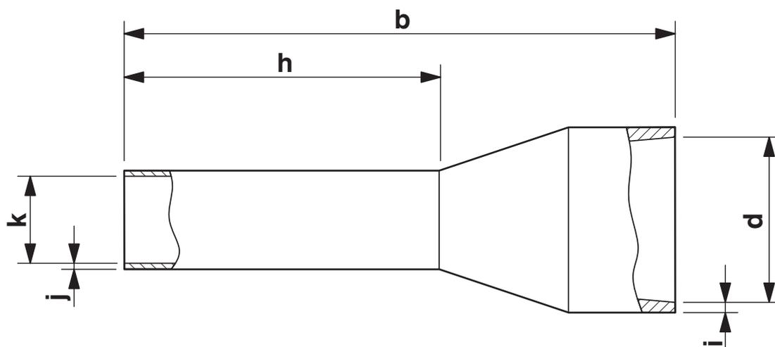
Longueur (b), longueur de la douille (h), cote intérieure du collier isolant (d), diamètre de la douille (k), épaisseur du collier isolant (i), épaisseur de la paroi de la douille (j)
