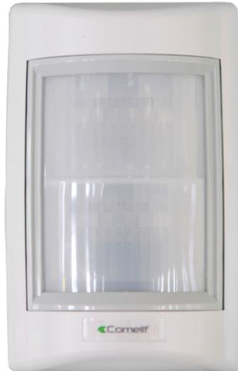
Détecteur double IR avec optique effet rideau à double élément d'extérieur en technologie ASIC permettant une analyse précise pour éliminer les fausses alarmes, alimentation de 9,6 à 16 Vcc, consommation au repos 18 mA, en condition d'alarme 8 mA, couverture 20 m, ouverture 2°, température de service de -20 a +50°C, protection IP 65, sortie alarme et contact de sécurité NF.
