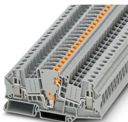
Bloc de jonction de sectionnement pour essais, tension nominale: 500 V, intensité nominale: 30 A, 1er étage, type de raccordement: Raccordement vissé, Section de référence: 6 mm<sup>2</sup>, section : 0,2 mm<sup>2</sup> - 10 mm<sup>2</sup>, montage: NS 35/7,5, NS 35/15, coloris: gris
