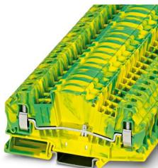
Bloc de jonction pour conducteur de protection, nombre de connexions: 2, type de raccordement: Raccordement vissé, section : 0,2 mm<sup>2</sup> - 10 mm<sup>2</sup>, type de montage: NS 35/7,5, NS 35/15, coloris: vert/jaune
