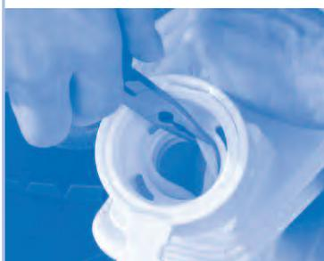
2 · Attention : L'épaulement du diaphragme doit être installé avec précision dans le logement qui lui est destiné ; pour cela, vous pouvez vous aider d'une pince, en prenant soin bien sûr de ne pas détériorer le diaphragme.
