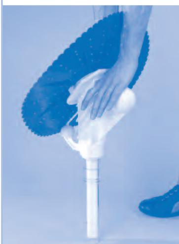
5 · Pour terminer, emboîtez d'un coup sec le tuyau de sortie externe dans le corps de l'aspirateur, en vérifiant qu'il tourne bien.
