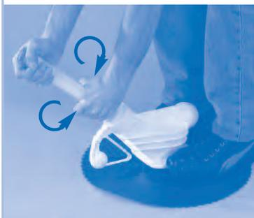
1 · Déboîtez le tuyau de sortie externe translucide de l'appareil. Pour cela, vous devez forcer manuellement sur ce tuyau transparent, en effectuant simultanément sur celui-ci une traction et un mouvement latéral.
