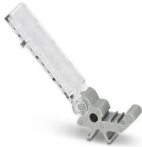
Étiquette de repérage, pour le repérage de groupes de blocs de jonction dont la rainure supérieure est inclinée à 60°, par exemple les bloc de jonction DIK, s'encliquette dans la rainure de repérage, la rainure spéciale pour étiquette pivote sur 120° et reçoit les étiquettes EST 24 x 4 ou ESL 24 x 4
