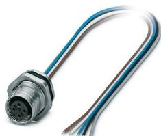
Connecteur d'appareil face arrière, Universel, 8-pôles, connecteur femelle, droit, M12-Push-Pull, détrompage: A, sur extrémité libre, Montage face arrière, Cordons individuels, longueur de câble: 0,5 m, 0,25 mm<sup>2</sup>, Cordon TPE
