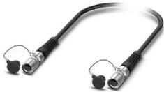
Série M17 avec assemblage de connecteurs à fibre optique préconfectionné : connecteur mâle-connecteur mâle 4 pôles, fibre de verre multimode G62. 5/125 µm OM1 avec raccordement vissé, longueur du câble fibre optique : 40 m, indice de protection IP67 après insertion, installation fixe dans des goulottes, des goulottes souterraines et des tubes de protection de câbles pour une utilisation en intérieur et en extérieur
