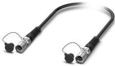
Série M17 avec assemblage de connecteurs à fibre optique préconfectionné : connecteur mâle-connecteur mâle 4 pôles, fibre de verre multimode G62.5/125 µm OM1 avec raccordement vissé, longueur du câble fibre optique : 60 m, indice de protection IP67 après insertion, installation fixe dans des goulottes, des goulottes souterraines et des tubes de protection de câbles pour une utilisation en intérieur et en extérieur
