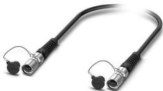
Série M17 avec assemblage de connecteurs à fibre optique préconfectionné : connecteur mâle-connecteur mâle 4 pôles, fibre de verre multimode G62. 5/125 µm OM1 avec raccordement vissé, longueur du câble fibre optique : 50 m, indice de protection IP67 après insertion, installation fixe dans des goulottes, des goulottes souterraines et des tubes de protection de câbles pour une utilisation en intérieur et en extérieur
