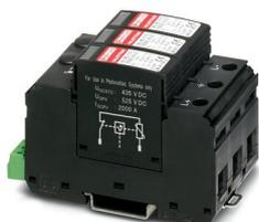
Dispositif paratonnerre / parafoudre pour systèmes à tension continue PV à 2 pôles, isolés et mis à la terre de 1 000 V DC, pour montage sur rail DIN, élément de base à 3 pôles avec contact de télésignalisation, trois éléments de protection enfichables, avec contrôle de la température, affichage de l'état sur chaque connecteur.
