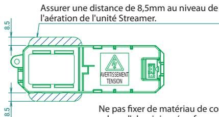
Ne pas fixer de matériau de conduction à moins de 20mm du ruban d'aluminium (sauf pour la vis de fixation de l'unité).
