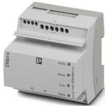
Centrale de mesure d'énergie multifonction sans écran avec raccordement Rogowski direct et interfaces Ethernet et CLOUD intégrées pour la mesure des paramètres électriques dans les installations à basse tension jusqu'à 690 V. ([phoenixcontact.com/empro-help](https://www.phoenixcontact.com/empro-help))
