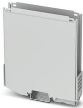
Boîtier électronique sur rail DIN, Partie inférieure du boîtier avec pied métallique de verrouillage, Etage 1 : fentes d'aération, largeur: 20 mm, hauteur: 100 mm, profondeur: 108,35 mm, coloris: gris clair (7035), connexion transversale: Connecteur de bus sur rail DIN (en option), nombre de pôles connecteur transversal: 8
