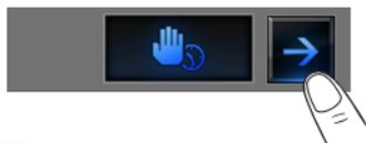
Les icônes et permettent d'abaisser et de diminuer la température par paliers de 0,5°C.
