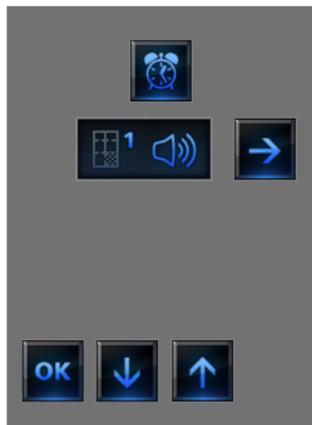
Il est possible d'établir les conditions de la diffusion sonore à l'activation du réveil (source, amplificateurs et volume).
