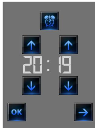
Utiliser les flèches pour programmer l'heure, chaque pression permet d'augmenter ou d'abaisser la valeur d'une unité, en maintenant l'icône enfoncée à l'aide du doigt l'augmentation ou la diminution intervient rapidement.
