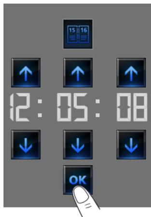
Utiliser les flèches pour programmer jour, mois et année, chaque pression permet d'augmenter ou d'abaisser la valeur d'une unité, en maintenant l'icône enfoncée à l'aide du doigt l'augmentation ou la diminution intervient rapidement.
