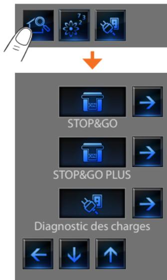
Pour chaque dispositif, l'état est affiché et en touchant l'icône
