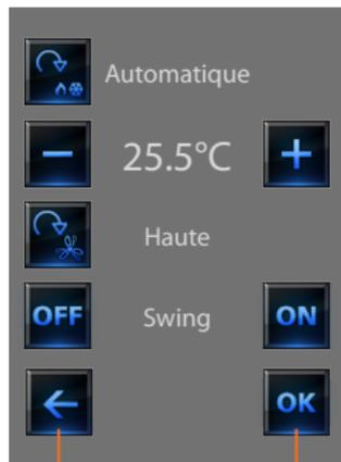
En touchant l'icône
