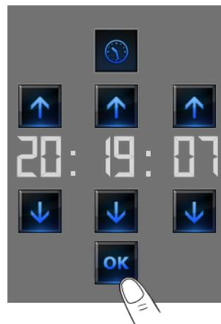
Utiliser les flèches pour programmer heure, minutes et secondes, chaque pression permet d'augmenter ou d'abaisser la valeur d'une unité, en maintenant l'icône enfoncée à l'aide du doigt l'augmentation ou la diminution intervient rapidement.
