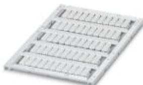
Manchon de repérage pour conducteur, Planche, blanc, vierge, repérable avec : THERMOMARK CARD, BLUEMARK CLED, BLUEMARK LED, LASER TOPMARK, THERMOMARK PRIME, Type de montage: enfilage, pour bloc de jonction au pas de : 5,2 mm, Diamètre du câble: 1,5-3,2 mm, Surface utile: 12 x 4 mm
