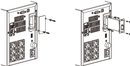
3. Connectez un câble d'interface réseau au connecteur réseau 10/100 Base-T (RJ-45) de la carte SNMP.
