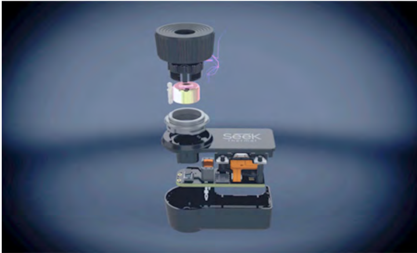
Figure 58 : Vue éclatée de la Compact montrant l'obturateur...
