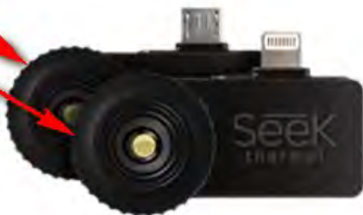
Figure 19 : Caméras Compact montrant les bagues de mise au point
