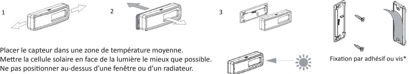
Placer le capteur dans une zone de température moyenne.
