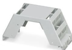
Boîtier électronique sur rail DIN, Partie supérieure du boîtier pour blocs de jonction C.I. à raccordement vissé, largeur: 45,2 mm, hauteur: 99 mm, profondeur: 45,85 mm, coloris: gris clair (7035)
