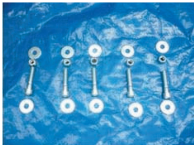
VIS M8x45 TCH ROND. 8,4x24 h2 ECROU AUTOFR. M8
