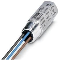
Parafoudre basse tension, pour un circuit de signalisation libre de potentiel de terre dans le module à visser, avec indice de protection IP67 pour têtes de capteur, raccordement 1/2" 14 NPT. Testé selon les classes de protection en atmosphère explosive Ex d / Ex tD / Ex ia IIC / Ex iaD. Pour système de bus de terrain en conception FISCO.
