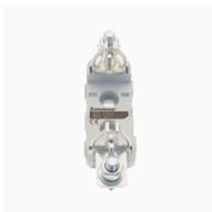
**Socle pour fusible, Basse tension, 160 A, AC 690 V, NH00, 1P, IEC, montage sur barre DIN, montage par vis**
