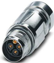
Connecteur prolongateur, droit, Pour verrouillage standard et SPEEDCON, M17, nombre de pôles: 6+PE, type de contact: Connecteur femelle, blindé: oui, indice de protection: IP67, plage de diamètre de câble: 10 mm ... 12,5 mm, nombre de pôles: 7, type de raccordement: Raccordement à sertir, série: ST, L'article est sans plomb, conformément à la directive RoHS II, sans exception 6c (Pb < 0,1 %)
