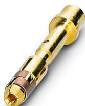
Contact à sertir, Connecteur femelle, tournés, diamètre de contact: 1 mm, zone de sertissage: 0,25 mm<sup>2</sup> ... 1 mm<sup>2</sup>, L'article est sans plomb, conformément à la directive RoHS II, sans exception 6c (Pb < 0,1 %)
