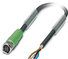
Câble pour capteurs/actionneurs, 4 pôles, PVC, noir RAL 9005, blindé, extrémité libre, sur connecteur femelle droit M8, longueur de câble : 10 m
