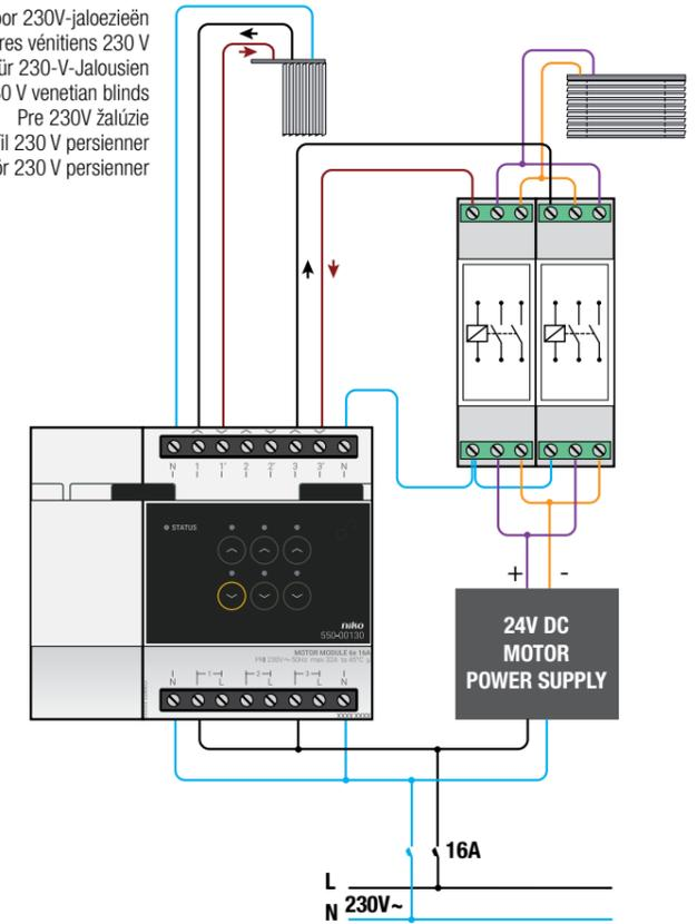
Voor de aansturing van 24Vdc-jaloezieën of 24Vdc-lamelten, heb je twee extra relais (geen Niko-product) nodig per jaloezie of lamel. Zo kun je de polariteit omdraaien en, bijgevolg, de draairichting van de 24Vdc-motor met slechts twee aansluitklemmen.
