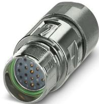
M23, Connecteur prolongateur, série: M23 PRO, droit, blindé: oui, Pour verrouillages rapides standard et ONECLICK, Nombre de pôles: 16+3, Sens de rotation: standard, type de contact: Connecteur femelle, Raccordement soudé, plage de diamètre de câble: 3 mm ... 15 mm, détrompage: N, L'article est sans plomb, conformément à la directive RoHS II, sans exception 6c (Pb < 0,1 %)
