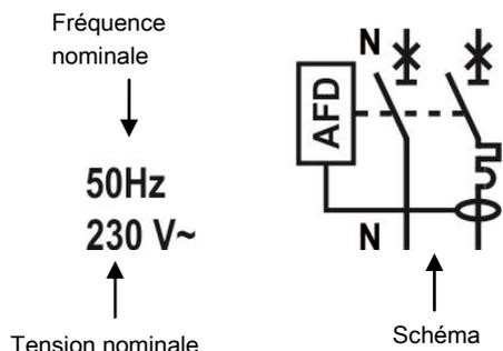
. Les bornes amont et aval du pôle neutre sont repérées par un « N » moulé à proximité des têtes de vis.
