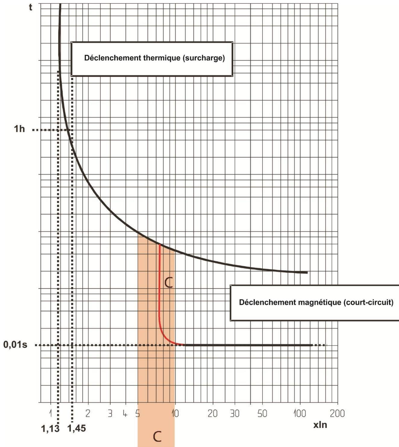
Déclenchement thermique à température ambiante = 30°C
