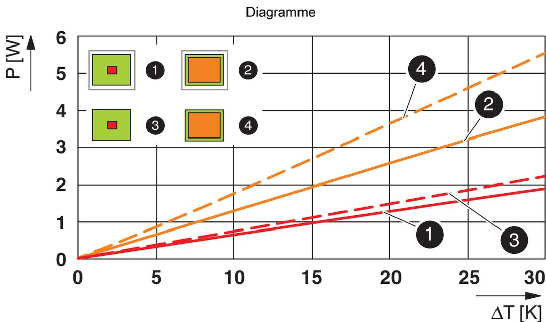
Diagramme de la puissance dissipée 0 K ... 30 K
