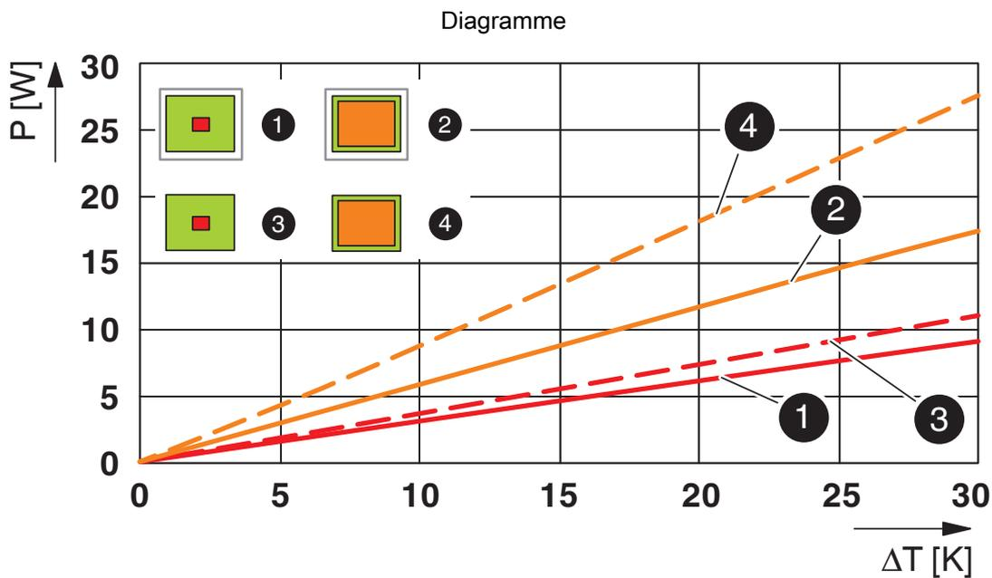
Diagramme de la puissance dissipée 0 K ... 100 K
