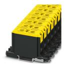
Bloc de jonction de puissance, tension nominale: 1000 V, intensité nominale: 145 A, nombre de connexions: 2, nombre de pôles: 1, type de raccordement: Raccordement vissé, Section de référence: 50 mm $^2$ , section : 6 mm $^2$  - 50 mm $^2$ , Section de référence: 50 mm $^2$ , section : 4 mm $^2$  - 50 mm $^2$ , type de montage: NS 35/15, NS 35/7,5, coloris: jaune
