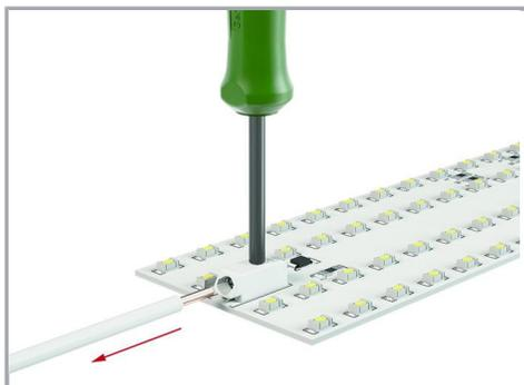
Raccorder les conducteurs rigides et déconnecter les conducteurs - en exerçant une légère pression sur le poussoir.
