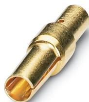
Contact à sertir, Connecteur femelle, tournés, Contact unique, diamètre de contact: 1 mm, zone de sertissage: 0,08 mm<sup>2</sup> ... 0,22 mm<sup>2</sup>, Produit de remplacement selon RoHS II sans exception 6c (Pb < 0,1 %) référence : 1241093
