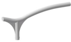
Support simple tête de poteau en tube acier galvanisé, 3 ou 4 mm d'épaisseur, peint avec de la poudre polyester. Fourni avec trois vis de blocage M8 en acier inoxydable pour la fixation sur des poteaux de diamètre de 60 mm.
