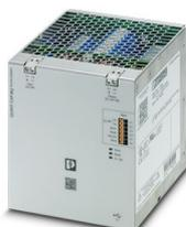
Module de capacité QUINT, avec accumulateur d'énergie sans entretien à base de condensateurs à double couche, Montage sur profilé, entrée: 24 V DC, sortie : 24 V DC / 10 A / 8 kJ avec adaptateur universel pour profilé UTA 107 monté. Pour le paramétrage, il est possible d'utiliser le logiciel POWER MANAGEMENT SUITE (Référence 1252232) disponible dans la zone de téléchargement.
